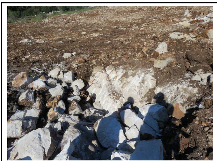
Foto 7. Čvrsta stijena od površine terena s pojavom pukotina ispunjenih glinom crvenicom
